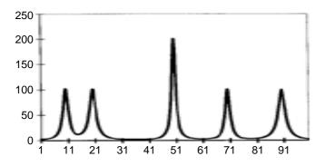
**Figure 1.** A low entropy spectrum, note that the information in the spectrum is concentrated into the relatively few peaks — *Spectre à basse entropie : l'information est concentrée seulement dans les quelques pics.*
