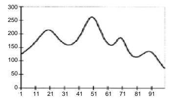
Figure 2. A high entropy spectrum, note that the relative width of peaks is greater than in the low entropy spectrum and the information is more widely spread across the spectrum — Spectre à haute entropie : la largeur des pics est plus grande que dans un spectre à basse entropie et l'information est plus dispersée sur la largeur du spectre.
