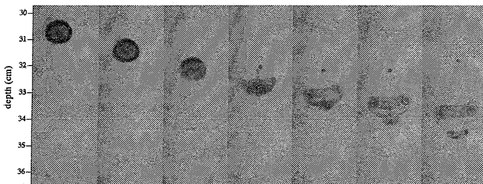
FIG. 13 – Mosaïque représentant l'explosion d'une antibulle chutant dans la colonne d'eau. Les images sont s par es de 15 ms. L'antibulle  clate   l'image 3. Le liquide contenu dans l'antibulle est brutalement mis en contact avec le liquide au repos de la colonne. Un premier vortex r sulte de ce choc. Sur les images 4   7, on distingue la bulle d'air r siduelle qui remonte   la surface. Un second vortex se forme sur l'image 6, il provient de la lib ration de la bulle d'air.
