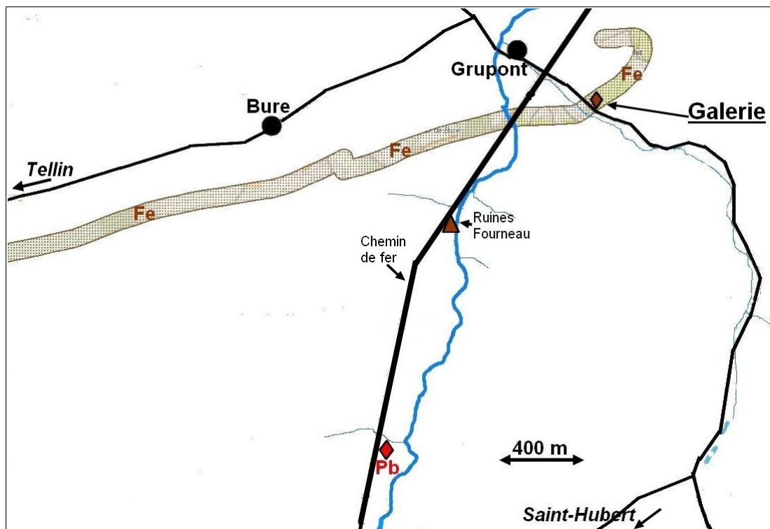
Figure 2 : Localisation de la galerie de Grupont dans la couche d'hématite oolithique du Dévonien inférieur, des ruines du haut-fourneau et de l'indice plombifère de Bure.
